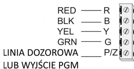
Rysunek 3 - Podłączenie do magistrali
