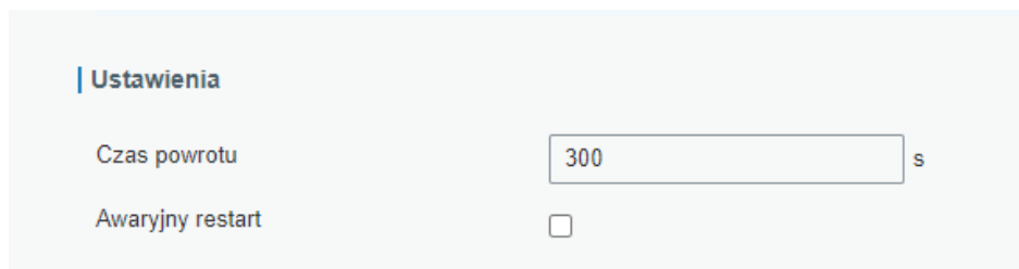
Rysunek 4.6 Ustawienia przełączania na interfejs o wyższym priorytecie
