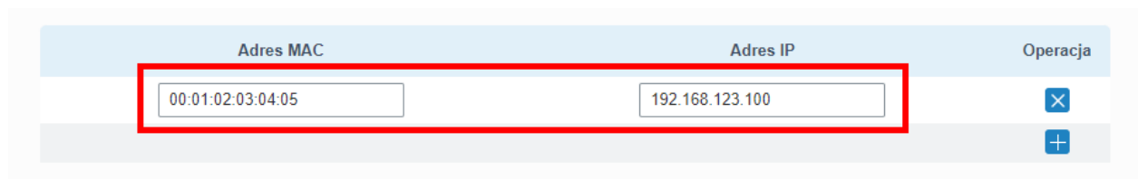
Rysunek 4.23 Dodawanie stałego IP dla klienta DHCP krok 2
