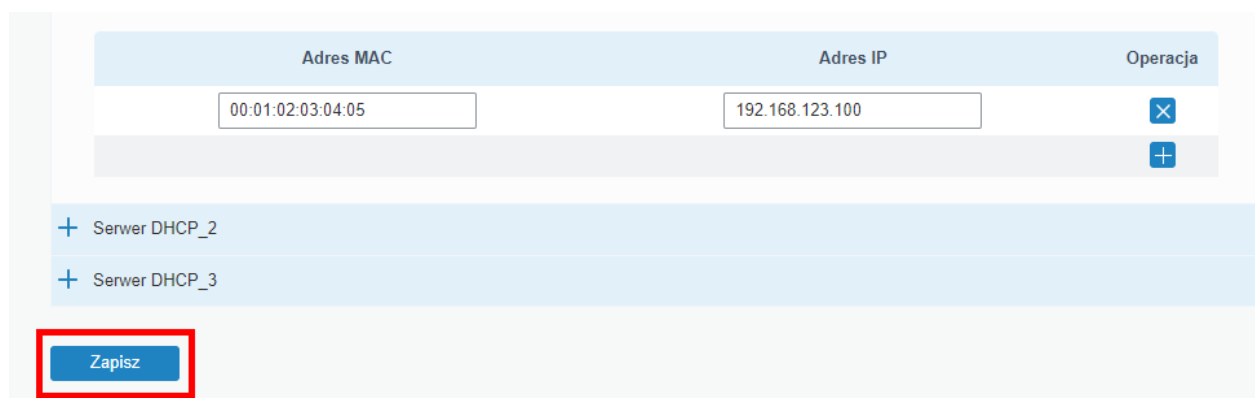
Rysunek 4.24 Dodawanie stałego IP dla klienta DHCP krok 4
