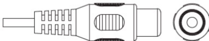
Rysunek 2-5 Gniazdo wejścia audio
